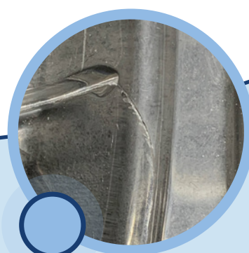
Geschädigte Oberfläche führt durch Kontakt mit Speisen zu VERFÄRBUNGEN
